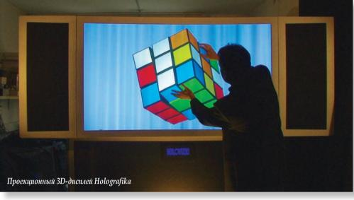
понятие угла обзора — насколько можно «сбоку» взглянуть за изображение. У них он самый большой на рынке. Устроено все так: внутри стоят 24 маленьких узких проектора (шириной примерно 4 см) и каждый проецирует на экран свое изображение. Угол зоны обзора — до 40...50° (это фантастически много и сравнимо с голографическими фотографиями).
